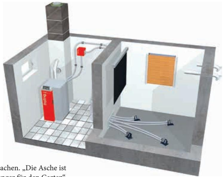
Die Pellets werden vollautomatisch aus dem Lagerraum angesaugt und im PE1 Pellet von Fröling hocheffizient verbrannt.
